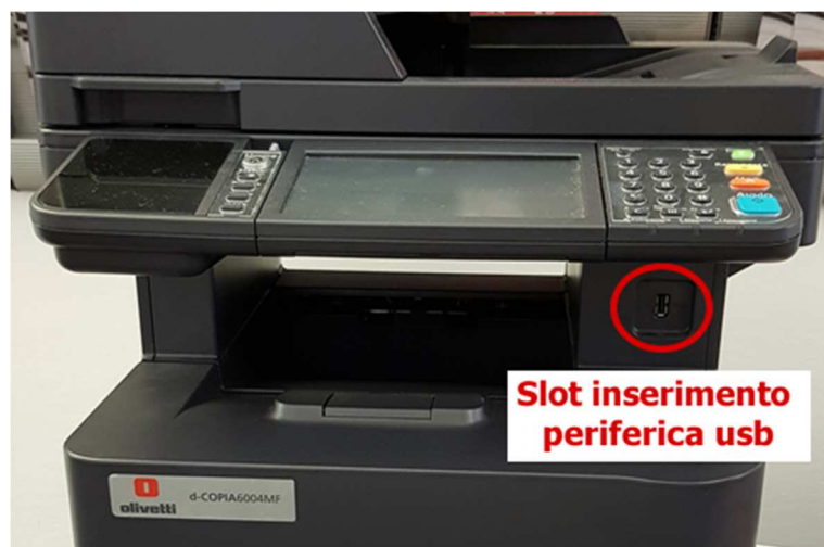
Dettaglio sullo slot dove collegare la periferica esterna usb
